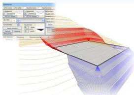
Esta potente funcionalidad permite definir vectores y aplicarlos automáticamente a una polilínea 3D cualquiera, generando una superficie 3D con sus taludes correspondientes.
