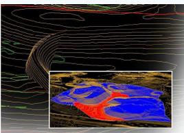
Puede obtener inmediatamente la medición de los volúmenes de desmonte y terraplén existentes entre dos superficies y por diversos métodos: por perfiles, por prismas, entre triangulaciones,...
